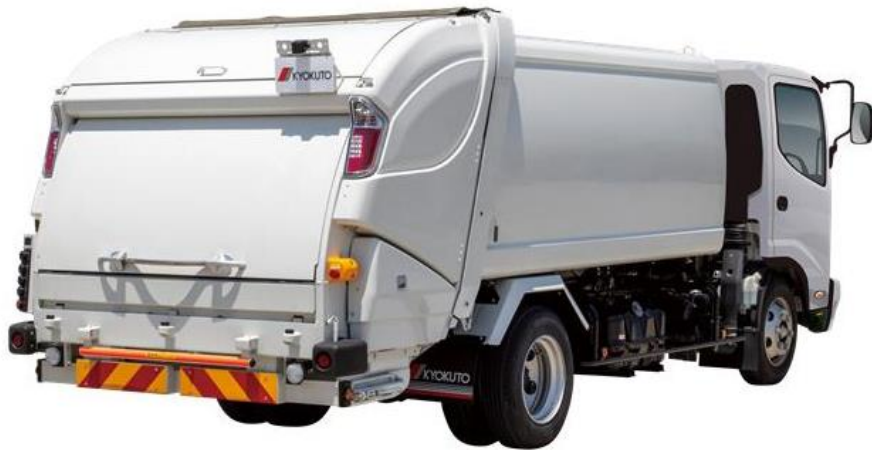
2t 車級回転板式ごみ収集車「パックマン®チルト」 (計量装置付ごみ収集車「シャフト式 スケールパッカー®」仕様)
