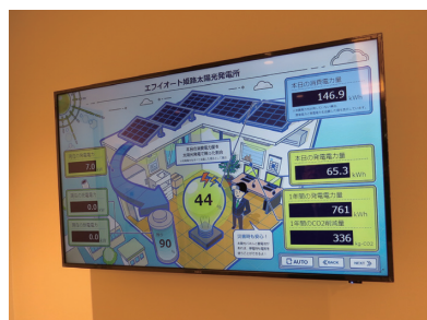
太陽光パネル管理モニター
