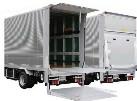
垂直昇降式テールゲートリフタ「パワーゲート®V800tilt」
