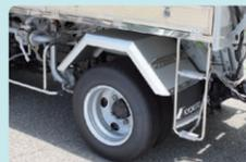
リヤフェンダをステンレス製または、アルミ製に変更できます。
