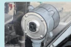
AC100Vの外部電源です。夜間給水時の照明装置などの電源として使用できます。
