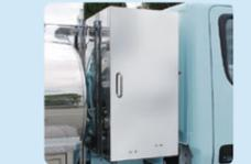
キャブバックに大型のツールボックスを取り付けます。給水用品や応援等による遠征時の備品を収納できます。
