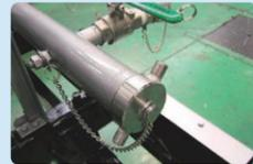
後方給水配管内を清掃できるので、配管内を清潔に保てます。
