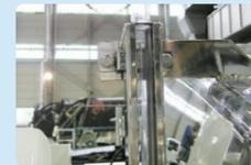
液面計にステンレス製カバーを取り付けることで、破損防止に役立ちます。
