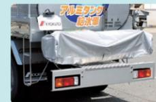
走行時等の給水配管の汚損防止に役立ちます。
