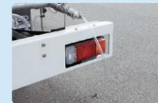
ペットボトルへの給水が出来るように先端が細口になっています。
