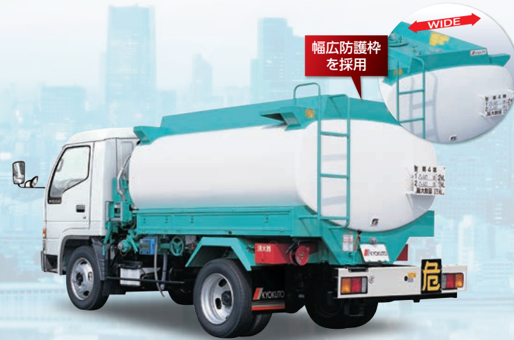
3.75kL積(角型タンク)
