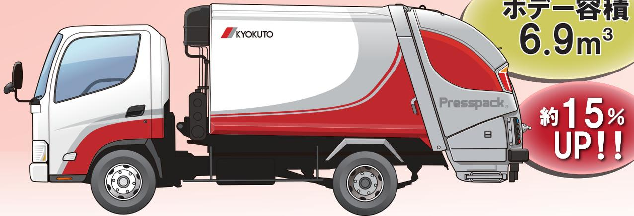
3.5tシャシ（ホイールベース 2,800 mmクラス）に架装し、ボデー容積を架装形式：GB59-230（ボデー容積 5.9 m<sup>3</sup>）より約15%アップすることで、機動性と無理のない効率的な収集作業を両立する高容積型仕様プレスパック<sup>®</sup>です。
