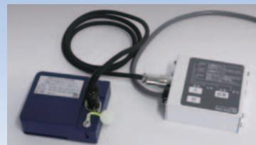
最大連続使用時間を約20時間に延ばした専用Ni-MHバッテリーパックを採用。充電器は使った分だけ充電できる通常充電と電池の性能を最適な状態に回復させ充電できるリフレッシュ充電を選択できます。充電ケーブルは分割ハーネス式で交換も簡単です。
