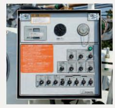
操作しやすく、ホッパ内の生コンの状況が見やすい位置に設けています。すべてスイッチ操作で圧送作業が簡単、確実に行え、オペレータとマシンの一体作業を実現します。作業に応じて、高速/低速の切換えができます。また、打設量の判定、チューブ交換や保守点検の目安となる積算式ロータ回転計をデジタル化させて、パネルに組込みました。
