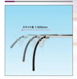
先端ホース位置の微調整が簡単に行えますので、ブーム先端付近が狭い現場での打設作業もより容易に行うことができます。
