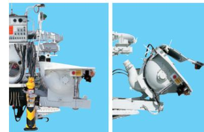
生コンの吸込効果が良く、残コンが少なく、洗浄も簡単な球形ホoppa。ポンピングチューブの交換時間に、作業スペースを大きく確保し、交換時間の短縮を図るチルト機能を装備させました。
