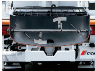
生コンが吸入口に集まりやすい舟底ホoppa。吸込み効率がよく、残コンが少なく、洗浄も簡単に行えます。
