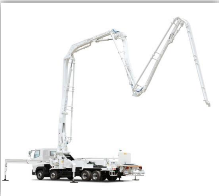
コンクリートポンプ車 (74.4%)
