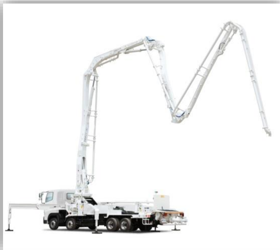
コンクリートポンプ車
