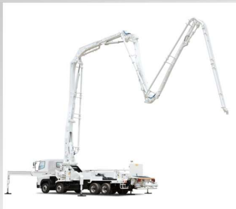
コンクリートポンプ車
