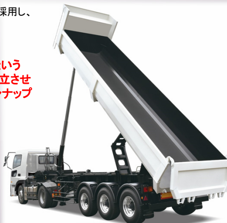
新型「テレスコ式土砂ダンプトレーラ (GVW36t)」
