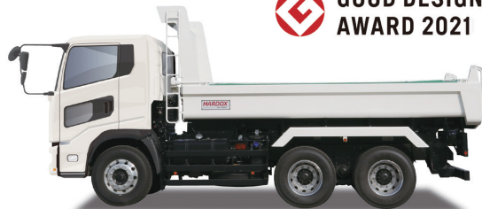
大型リヤダンプトラック耐摩耗鋼板 (HARDOX) 仕様
