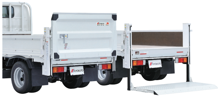
パワーゲート V型プレスゲート(V600) (プラットフォームサイズ: W1,570mm×H870mm)
