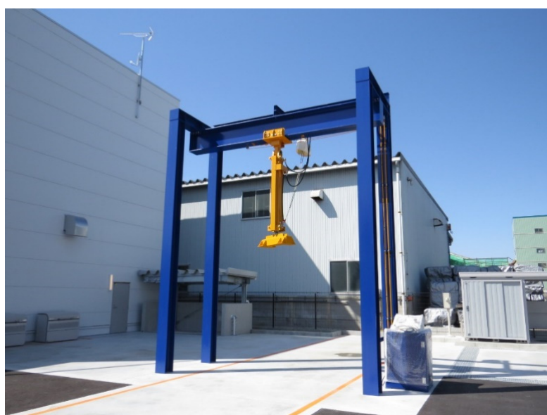
自重計用荷重試験装置 (レーン長:18.5m ・ 最大能力 30t)
