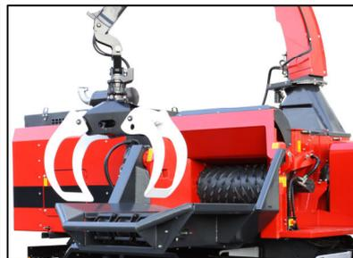
クレーン・木材供給装置により
