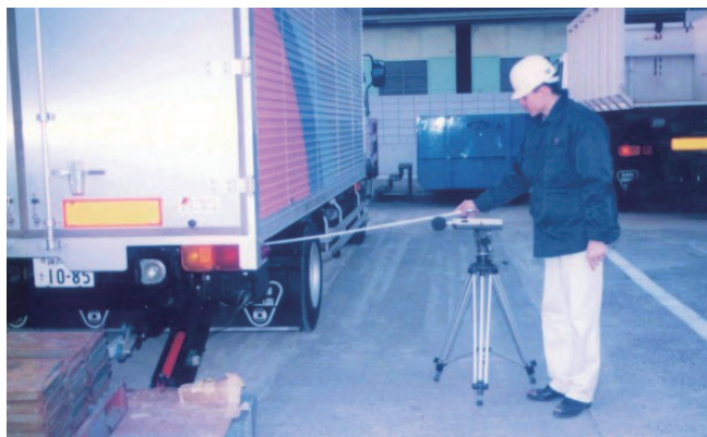
図22 パワーユニット騒音測定
