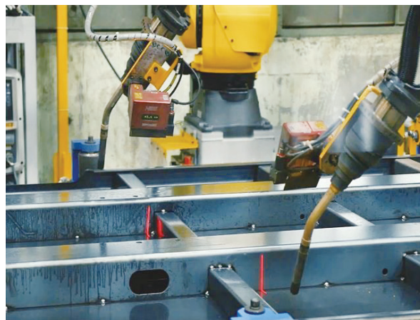
レーザセンサによる溶接個所の検知
