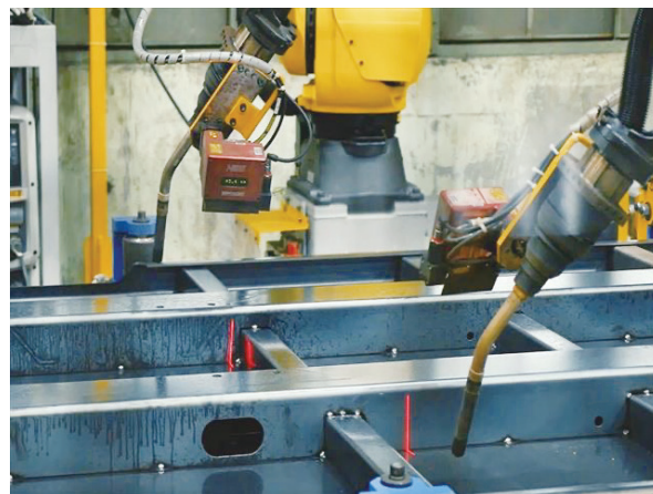
レーザセンサによる溶接個所の検知
