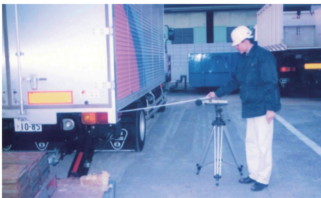
図22 パワーユニット騒音測定
