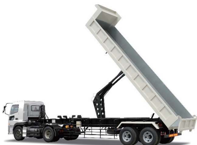
写真13 総重量26トン土砂ダンプトレーラ (ボデー内法長8,300mm)
