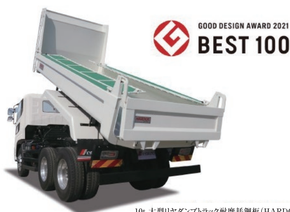
10t 大型リヤダンプトラック耐摩耗鋼板(HARDOX)仕様 (オプション装着車)
