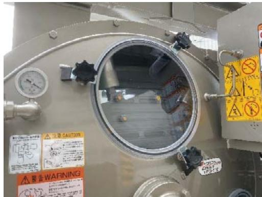
図8 ケースカバーに設けた検知窓
