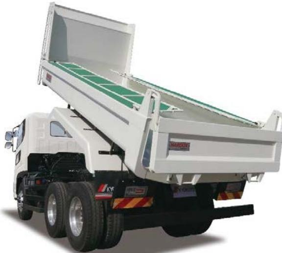
10tダンプ耐摩耗鋼板(HARDOX)仕様
