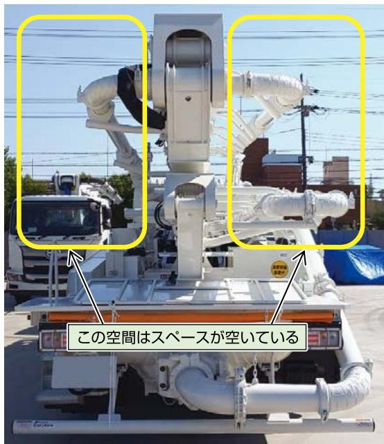
図9 M型4段屈折ブーム構造 車両後方視
