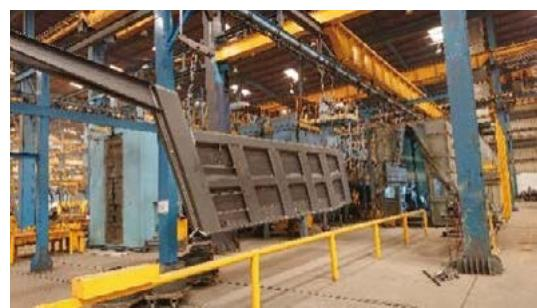
18 m<sup>3</sup>ダンプのサイドパネル L8,720mm×H2,620mm
