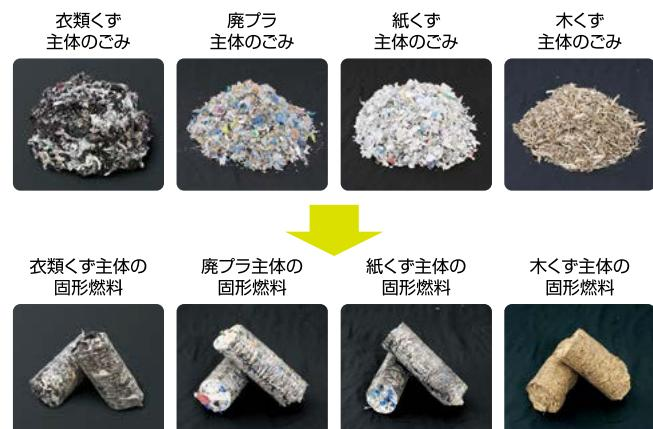
図3 極東開発工業製の突き押し式成形機で製造したブリケット
