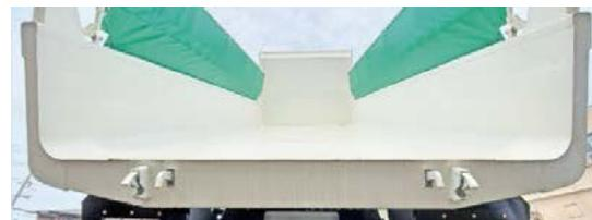
R型構造とデッキ3枚構造
