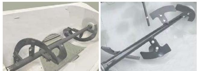
図17 スクリュープレード(左)と従来のプレード
