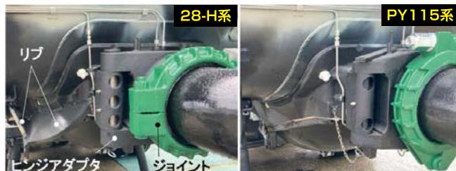
図26 Sバルブの高圧対応
