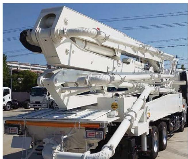
図4 M型4段屈折ブーム構造のブーム格納時
