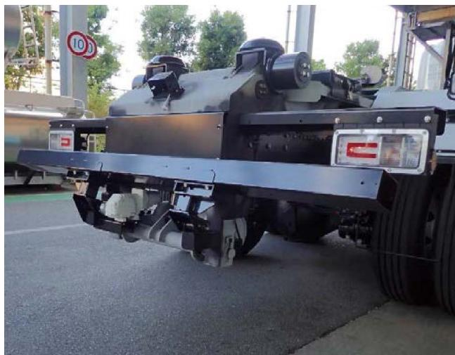
図20 フックロール 可倒式リヤバンパシステム
