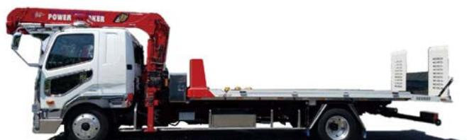
図23 クレーン付きフラットップ架装
