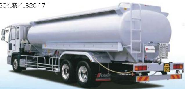
写真8 アルミ20kLタンクローリ(押出フレーム構造)
