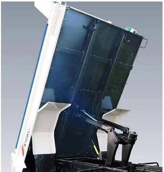
【図3 補強部材を削減したデッキ裏構造】
