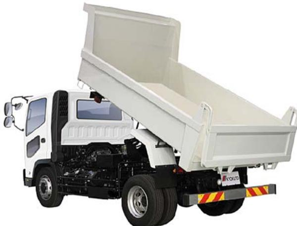
7tダンプ耐摩耗鋼板(HARDOX)仕様ボデー
