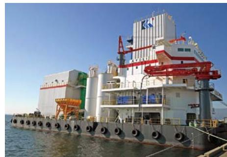
コンクリートミキサ船全体(全長66m 全幅24m 全高25m)
