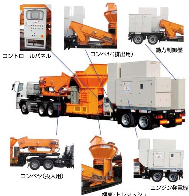
【図11 移動式破碎機】
