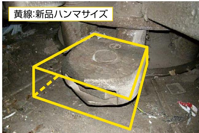
【図4 ハンマヘッド摩耗状況(58型)】
