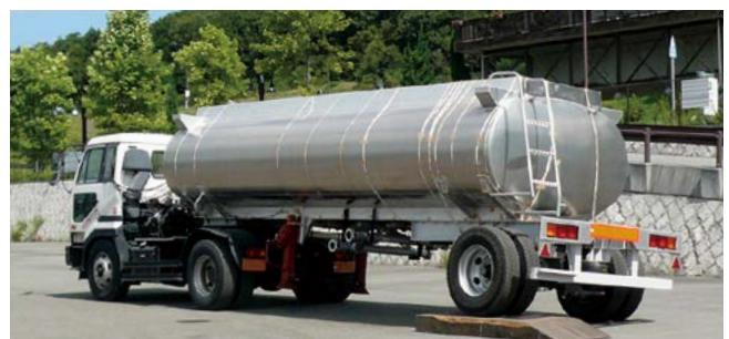
写真11 20KL(KTT101型)タンク基準路試験
