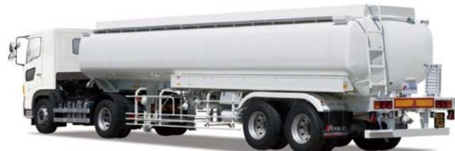
写真14 30kL積載(KTT2301S)タンクトレーラ
