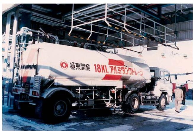
写真4 アルミ18kL角型タンクセミトレーラ
