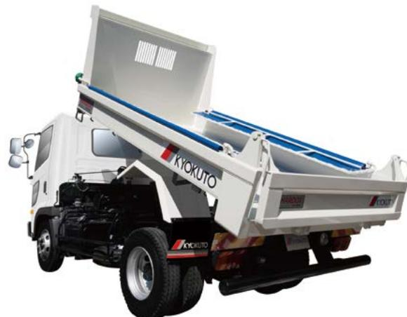
中型リヤダンプトラック耐摩耗鋼板(HARDOX)仕様
