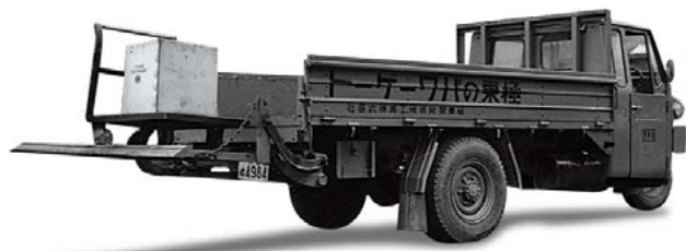
ダイハツ3輪トラックに架装されたパワーゲート初号機
