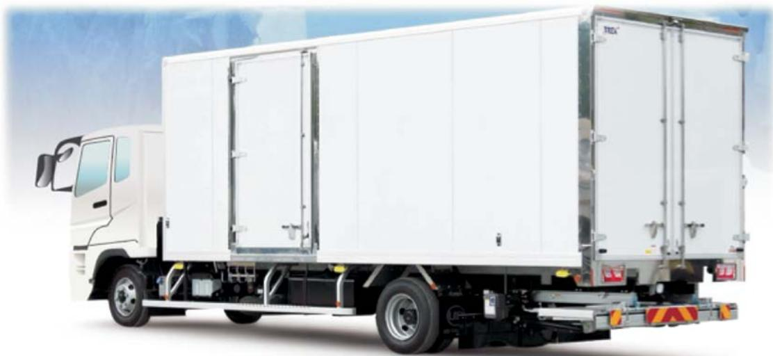
フラットパネルバンボデーは、外板・断熱材・内板で構成される複合パネルを使用した箱型車体で、主に冷凍機を装備して品物の温度を一定に保ちながら輸送することを目的とした車両です。
