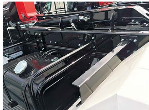
写真7 モジュール孔を利用したボルト締結
