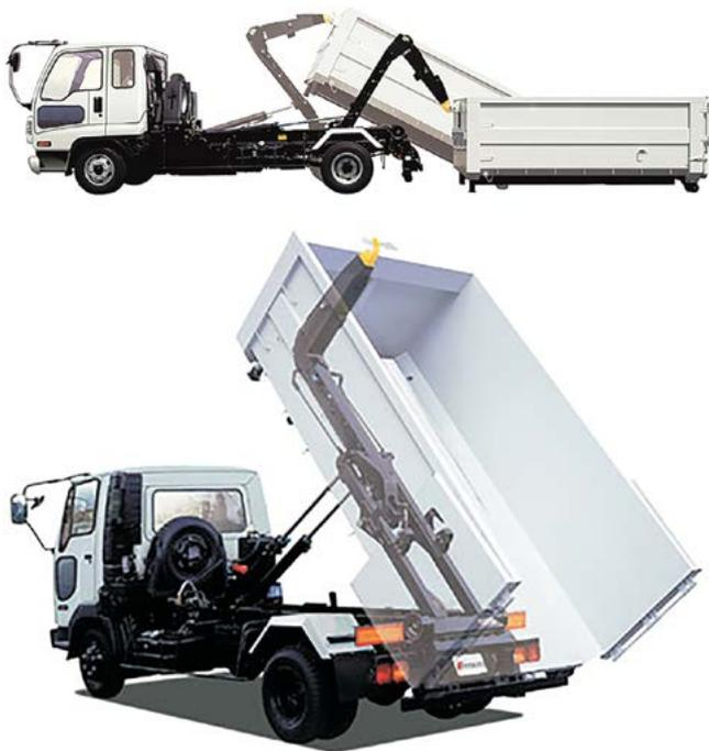
写真2 コンテナ脱着、ダンプ機構
