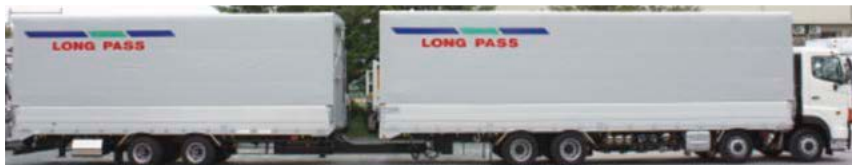
▲全長20,985mm（トラクタ11,990mm・トレーラ10,460mm）、全幅2,495mm、全高トラクタ3,790mm・トレーラ3,770mm、最大積載量25,000kg（トラクタ13,300kg・トレーラ11,700kg）。
