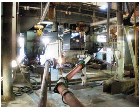
写真2 二次製品生産工場で行った事前の実打設テスト
