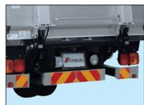
大型後部反射器取付
