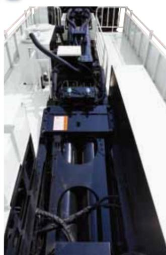
高圧大容量ポンプユニットにより、最大能力値及び実用域とされる中間作業能力域での能力向上を実現。少量打設から高圧・大容量打設まで多様な現場に対応したオールマイティ対応機種としてあらゆる現場で活躍します。また、最高油圧を「高」「中」「低」の3段階設定とすることで、配管打設作業における最適設定に対応しています。
