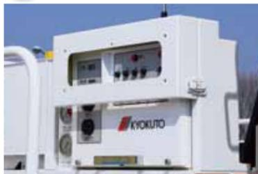
見やすく、操作しやすい位置に操作パネルを設置。確実な圧送作業をもたらします。生コン吐出量をデジタル表示する吐出量計を装備。
