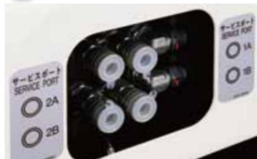
サービスポートを2組、標準装備しており同時に2台の油圧式ストップバルブの動力源を供給することが可能です。
