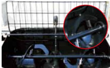
骨材のかみ込み時に威力を発揮するオートリバース機構と生コンの押込み性が優れたスクリーブタイプのブレードを標準装備しています。
