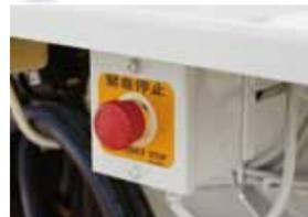
ホッパサイドに装着されています。緊急時押すことにより、ポンプ、ホッパブレードの作動が停止する安全装置です。
