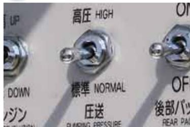
スイッチひとつで、標準圧送と高圧圧送の切換えができ一般的な打設状態から長距離・高所打設に素早く対応することが可能です。
