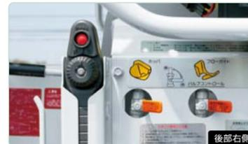
従来の操作レバーを廃止し電子制御コントローラを設置。電子制御コントローラの届く範囲であればどこでも排出作業を見ながら微調整することができます。(シュート旋回全域で操作可能。)
