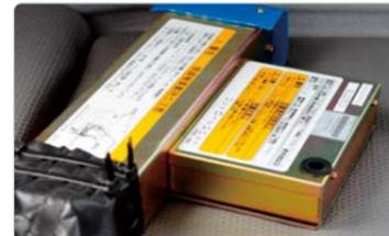
ミキサー制御を司るECU(Electronic Control Unit)はフェールセーフ機能で異常時にLEDが点灯表示します。
