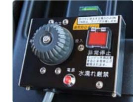
キャブ内にコントローラを搭載し、ダイヤル操作で「投入」「排出」「停止」を可能にしています。また自動攪拌解除ボタンや非常停止ボタンも装備し安全面にも配慮しています。
