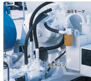
エンジンを低速回転のままドラムを高速回転することができますので、「投入」「混練」「排出」「洗浄」作業の低騒音、排出ガス低減を実現しました\*。また走行中のドラム逆回転の防止、攪拌回転の自動制御、生コン打設前のワンタッチ自動混練や省エネ設計による低燃費など、現場にも環境にも優しいシステムです。
