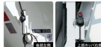
リヤワンハンドコントローラは後部右側、後部左側と上部ホッパー右側の3カ所に配置。ダイヤル操作で「投入」「排出」「停止」「アクセル操作」を可能にしています。また後部右側に配置のシャワーバルブ、自動混練・自動洗浄のスイッチをシンプルに集中化しています。
