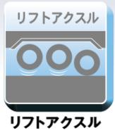
エアサスペンション機構により3軸の前2軸のリフトアップを可能にしました。これによって片路空荷輸送時の1軸走行を可能にし、高速料金のコスト軽減や、タイヤの摩耗減少によるランニングコストを軽減することができます。注) 連結トラクタ及び通行経路によって高速料金は異なります。詳細は弊社営業担当にお問い合わせください。
