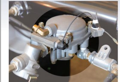
リレーバルブをサーモスタートによって暖め、-30℃までのバルブの凍結を防止、厳寒期の素早いトレーラ発進を実現した凍結防止ヒーターです。
