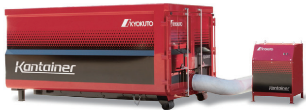
木質チップ乾燥コンテナシステム「Kantainer」
