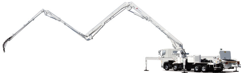
コンクリートポンプ車 (ピストンクリート®PY100-36A-S)
