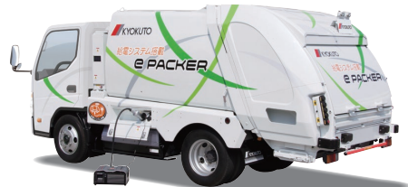
電動式塵芥収集車 (eパッカー® (給電システム搭載車))
