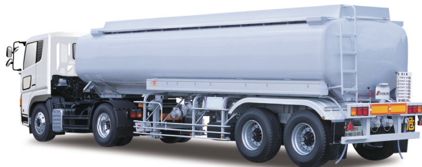
24KL角形アルミタンクセミトレーラ
