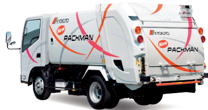
回転板式ごみ収集車 (2トン パックマンチルト®)
