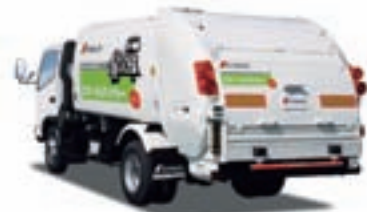
計量装置付ごみ収集車 (スケールバックカー / 3.5t 車級)
