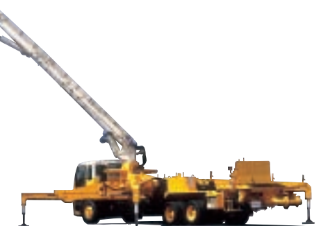
▲ コンクリートポンプ車
