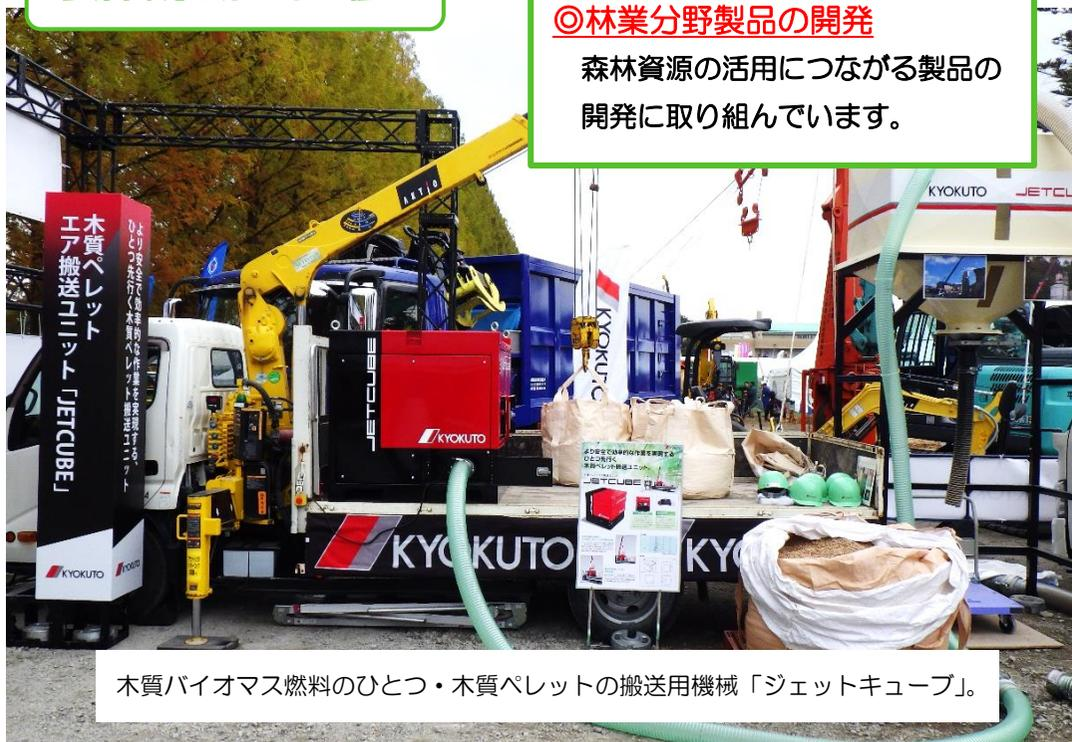
木質バイオマス燃料のひとつ・木質ペレットの搬送用機械「ジェットキューブ」。
