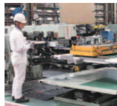
パワーゲート。荷重テスト
