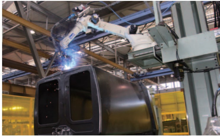
ごみ収集車ボデー溶接ロボット
